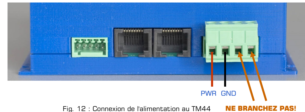
Fig. 12 : Connexion de l'alimentation au TM44
